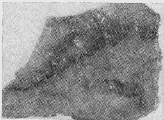
Рис. 1. Чешуйки тетрадимита (белое) в ассоциации с турмалином (черное) в кварцевой жиле. Рудопроявление Верхняя Куянда, обр. 1642. Natur. вел.
