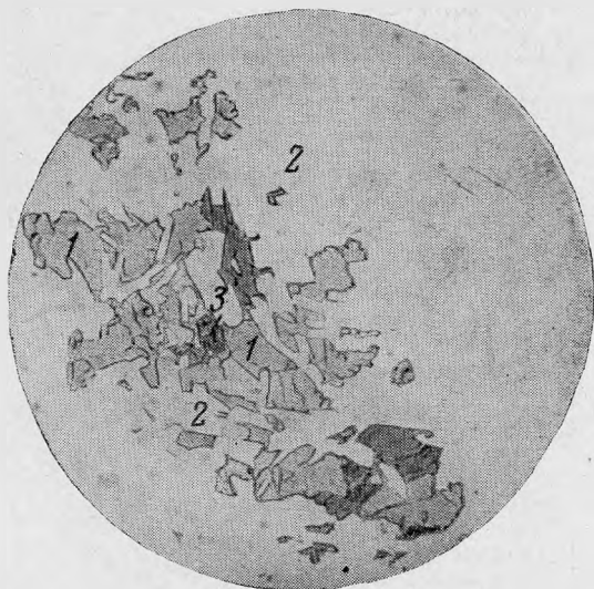
Рис. 1. Ловенит 1 корродирован альбитом 2. Внутри ловенита зерно малакона 3. Прозрачный шлиф, \times 18 . Без анализатора
