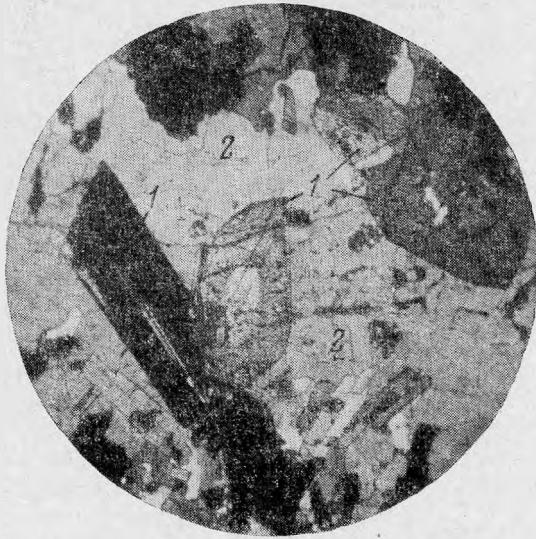
Рис. 2. Полисинтетически сдвойникованные призматические кристаллы ловенита зонального строения 1 в канкрините 2. Прозрачный шлиф, \times 30 . Николи +
